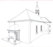
Photogrammetrische 3-D-Auswertung, Datenaustausch im DXF-Format
