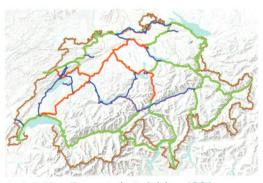
Abb. 1: Nivellement de Précision 1864–1891: blau: einfache Beobachtungen, rot: doppelte Beobachtungen in gleicher Richtung, grün: doppelte Beobachtungen in inverser Richtung.
