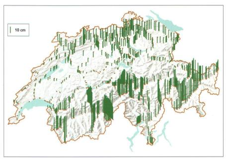
Abb. 3: Differenzen orth. Höhen LHN95 - Gebrauchshöhen LN02.
