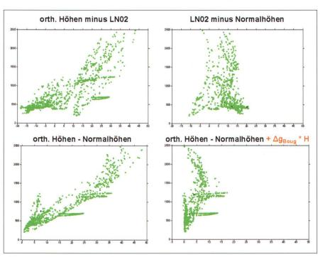
Abb. 4: Korrelation der Differenzen mit der Höhe.
