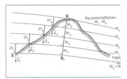
Abb. 1: Prinzip der strengen Höhenbestimmung beim Nivellement (aus [7]).
