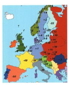
Abb. 6: Unterschiede in [cm] der nationalen Höhensysteme zum europäischen Höhensystem (aus Ihde/Augath, 1999 [3]).
