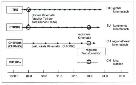
Abb. 1: Dynamische und statische Bezugssysteme.
