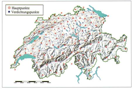
Abb. 4: GPS-Netz LV95 (Haupt- und Verdichtungspunkte), Endzustand 2001.
