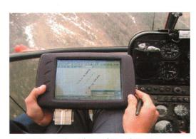
Fig. 5: Lignes de vol avec les points mesurés précédemment au sol et indication en temps réel de la position de l'Hélicoptère (radar monté à la verticale de l'antenne GPS).
