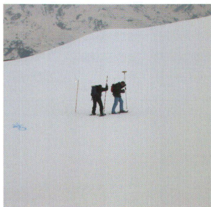
Fig. 3 et 4: Mesures de contrôle par GPS-RTK et sonde, ainsi que par carottage.
