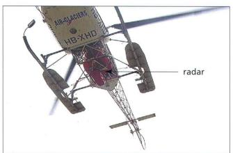
Fig. 1: Hélicoptère avec Radar et GPS.
