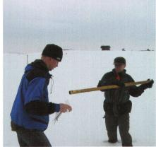
Fig. 3 et 4: Mesures de contrôle par GPS-RTK et sonde, ainsi que par carotage.
