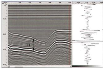
Fig. 2: Scan radar en temps réel (interface neige-sol).
