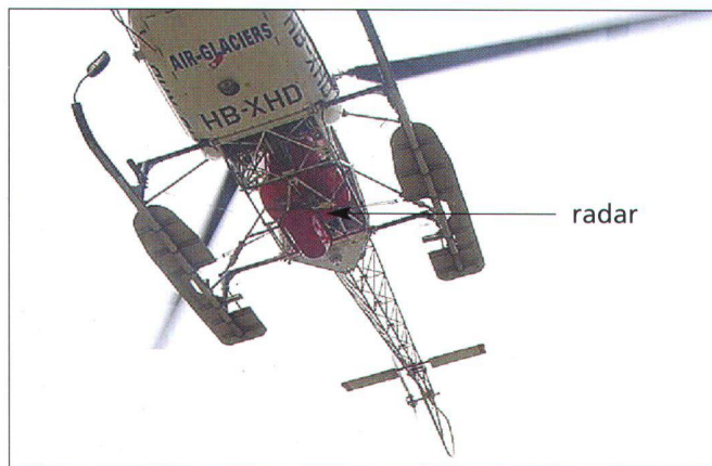
Fig. 1: Hélicoptère avec Radar et GPS.
