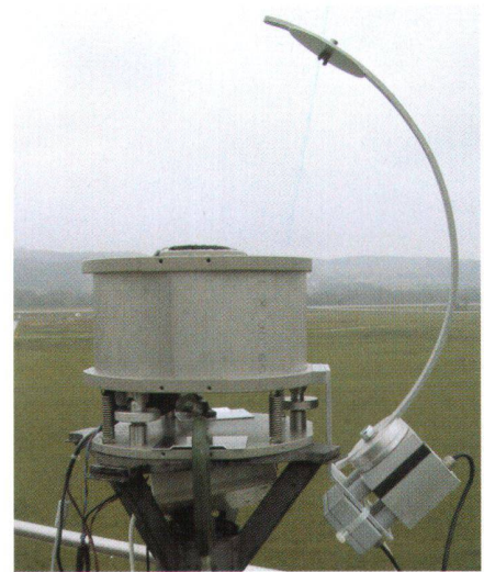
Abb. 1: CCD-Kamerasystem zur terrestrischen Wolkenmessung.
