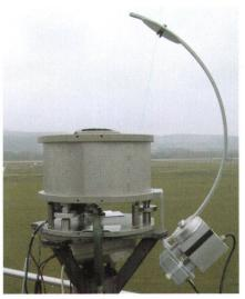
Abb. 1: CCD-Kamerasystem zur terrestrischen Wolkenmessung.
