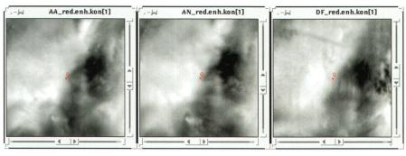
Abb. 5: LSM Matching zwischen den einzelnen MISR Aufnahmerichtungen. Zu beachten sind die viel grösseren Unterschiede von AA/AN zu DF, als zwischen den benachbarten Aufnahmerichtungen AA und AN.
