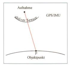
Abb. 2: Grundmuster des Laser-Scannings bzw. der neuzeitlichen Photogrammetrie.
