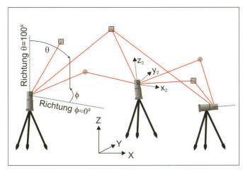
Abb. 4: Blockausgleichung mit «unabhängigen Modellen».
