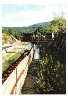
Abb. 2: Die ingenieurbiologische Versuchsstrecke bei Hadersdorf-Auhof am Wienfluss kurz vor der Flutung. Rechts von der Trennwand sind die Grünlagen sichtbar, die bei der Flutung vollständig abgelegt wurden. Im Hintergrund die Messbrücke. Links von der Trennwand sind die zu testenden harten Sohleinbauten sichtbar.
