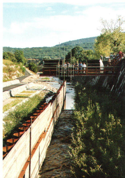
Abb. 2: Die ingenieurbologische Versuchsstrecke bei Hadersdorf-Auhof am Wienfluss kurz vor der Flutung. Rechts von der Trennwand sind die Grünlagen sichtbar, die bei der Flutung vollständig abgelegt wurden. Im Hintergrund die Messbrücke. Links von der Trennwand sind die zu testenden harten Sohlembauten sichtbar.
