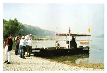
Abb. 4: Donau stromaufwärts bei Haslau-Orth a. Donau. Hinter dem Pontonboot sind die Buhnen sichtbar, die die Fahrrinne einengen und diese besser befahrbar machen.
