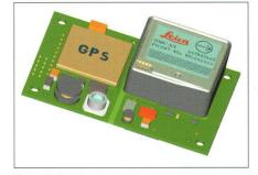
Fig. 1: Pedestrian Navigation System (PNS) produit par Leica Vectronix en étroite collaboration avec le laboratoire de Topométrie (EPFL). Un système de localisation tridimensionnelle complet pour moins de 50 grammes.
