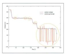
Fig. 5: Détection de perturbations magnétiques.
