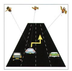
Fig. 1: Détection du changement de voie.
