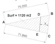
$\overline{DE}$  // à  $\overline{BC}$ SURF.ABC = 1120 m<sup>2</sup> SURF.DBCE = 400 m<sup>2</sup> X = ?
