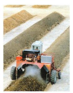
Abb. 7: Spezialumsetzungsmaschine während der aeroben exothermen Hitzerotte.
