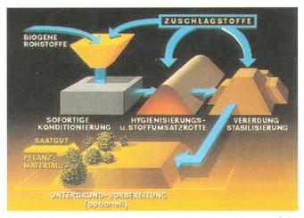
Abb. 6: Schematische Darstellung des Vererdungsverfahrens.
