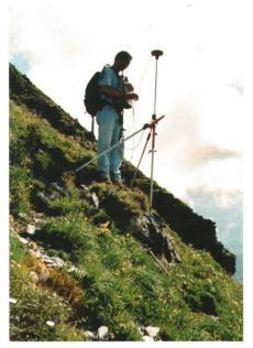
Fig. 3: Implantation et relevé d'un point de la limite cantonale à l'aide de GPS-RTK.
