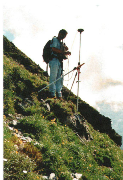
Fig. 3: Implantation et relevé d'un point de la limite cantonale à l'aide de GPS-RTK.
