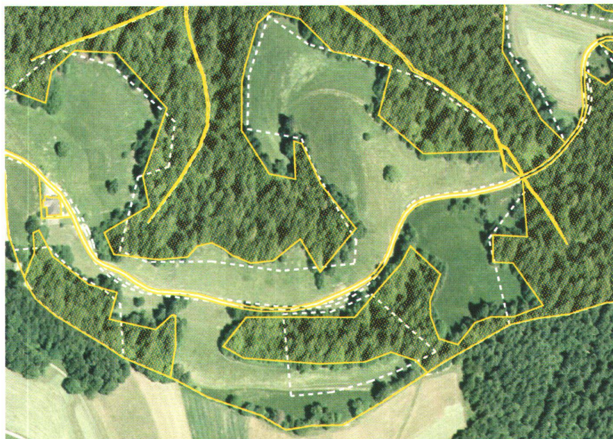
Abb. 2: Alte und neue Bodenbedeckung, Ausschnitt aus der Gemeinde Eriswil (weiss gestrichelt = Abgrenzung von 1880, gelb = aktualisierte Bodenbedeckung). SWISSIMAGE/DOM-AV © Bundesamt für Landestopographie (BA024240).
