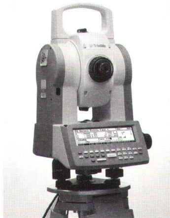
3600: der einzige Tachymeter mit kabelloser (Infrarot) Datenübertragung (mit Zeiss- oder Geodimeterbedienung).
