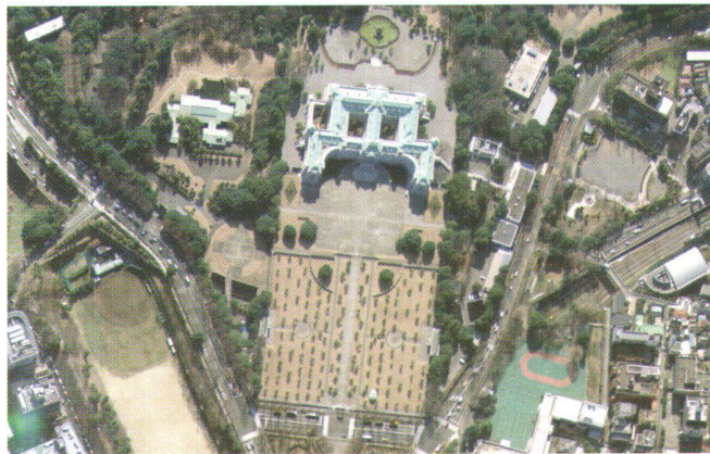
Links: Stadtzentrum von Tokio, aufgenommen aus einer Flughöhe von 2900 Meter über Grund von PASCO am 28. Januar 2002 mit dem Leica Geosystems Flugaufnahme-Digitalsensor ADS40 in sieben unterschiedlichen Bändern für die dreidimensionale digitale photogrammetrische Auswertung, Fernerkundung und Erstellung eines Geographischen Informations-Systems (GIS). Die Bodenpixelgrösse in dieser Datei beträgt 0,3 m. Bildausschnitt rechts: Das Dateidetail zeigt das Staatsgästehaus.
