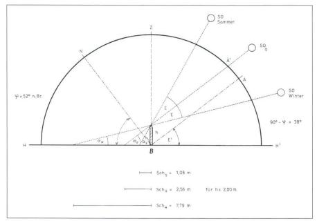
Abb. 3: Schema der Schattenmessung in  $52^{\circ}$  nördl. Breite zur Sommersonnenwende (s), Äquinoktium (ä) und Wintersonnenwende (w). Schattenlänge (Sch) für Gnomon h = 2,0 m.
