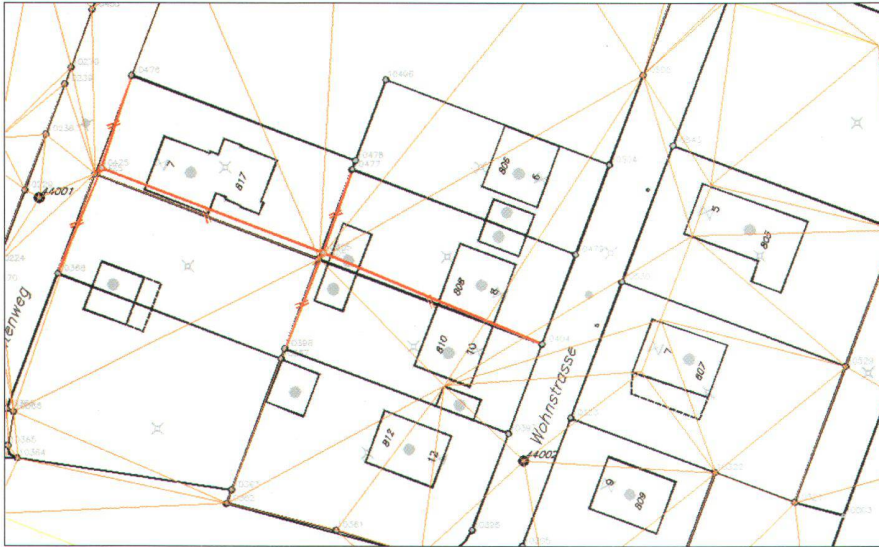
Abb. 1: Ausgangssituation und Dreiecksvermaschung.
