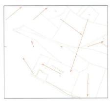
Abb. 3: Verschiebungsvektoren der Rasterentzerrung.
