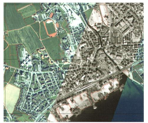
Abb. 2: Ausschnitt aus dem Ikonos-Satellitenorthofoto des Kantons Zug. Diese Bilder weisen eine räumliche Auflösung von 1m im panchromatischen Modus (diagonaler Streifen) bzw. 4m im multispektralen Modus auf. Solche Bilder sind für den ganzen Globus verfügbar und können mit einer speziellen Software und einem digitalen Höhenmodell präzis orthorektifiziert werden. Auftraggeber: © GIS-Fachstelle des Kantons Zug, Swissphoto AG.
