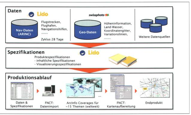
Übersicht über die Kartenproduktion: Aus unterschiedlichen Datenquellen werden die Daten importiert und aufbereitet. Was auf der Karte dargestellt werden soll, definieren die inhaltlichen Spezifikationen; wie ein Element dargestellt werden soll, die Visualisierungsspezifikationen. Die Umsetzung der Visualisierung von Daten auf der Karte erfolgt mit dem GIS-basierten Flight Navigation Charting Tool (FNCT) der Swissphoto AG basierend auf ESRI ArcInfo 8.1.
