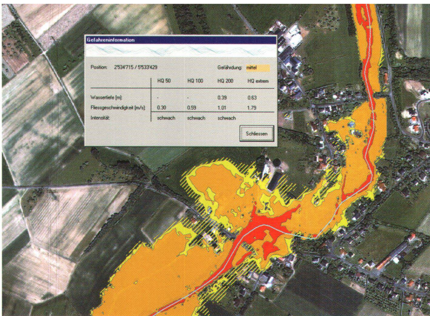
Abb. 4: GIS-Atlas Mosel. Diese interaktive GIS-Applikation basiert auf ArcView 8 und wurde mit Hilfe von ArcObjects entwickelt. Die Funktionalität wurde auf die Gefahrenkartierung von Überschwemmungsgebieten ausgerichtet. Auftraggeber: Ministerium des Innern, Luxemburg sowie Wasserwirtschaftsverwaltung Rheinland-Pfalz (ehem. StAWA Trier), gefördert durch das europäische IRMA-Interreg Programm.
