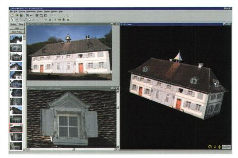
Abb. 2: Konstruktion des Westflügels mit PhotoModeler.
