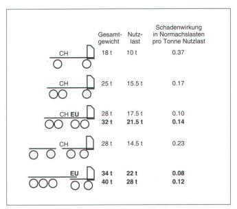
Abb. 2: Schadenwirkung (Achslastäquivalenzfaktoren) pro Tonne Nutzlast.
