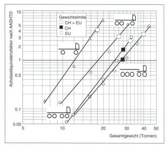
Abb. 1: Schadenwirkung in Normachslasten (Summe der Achslastäquivalenfaktoren) in Funktion des Gesamtgewichts für verschiedene Lastwagentypen.
