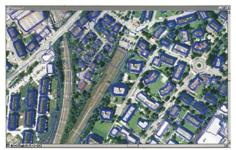
Abb. 8: Qualitätskontrolle DOM/2.5: Überlagerung der Höhenlinien im Swissphoto-Orthophoto.
