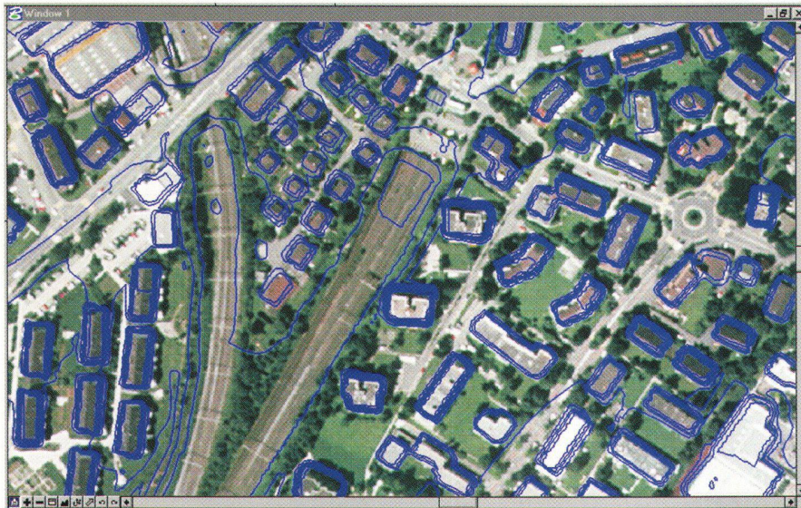
Abb. 8: Qualitätskontrolle DOM/2.5: Überlagerung der Höhenlinien im Swissphoto-Orthophoto.
