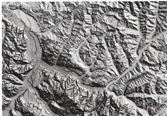
Abb. 3: Shaded Relief des digitalen Oberflächenmodell DOM/10 vom LK25 Blatt 1168 Langnau i.E.
