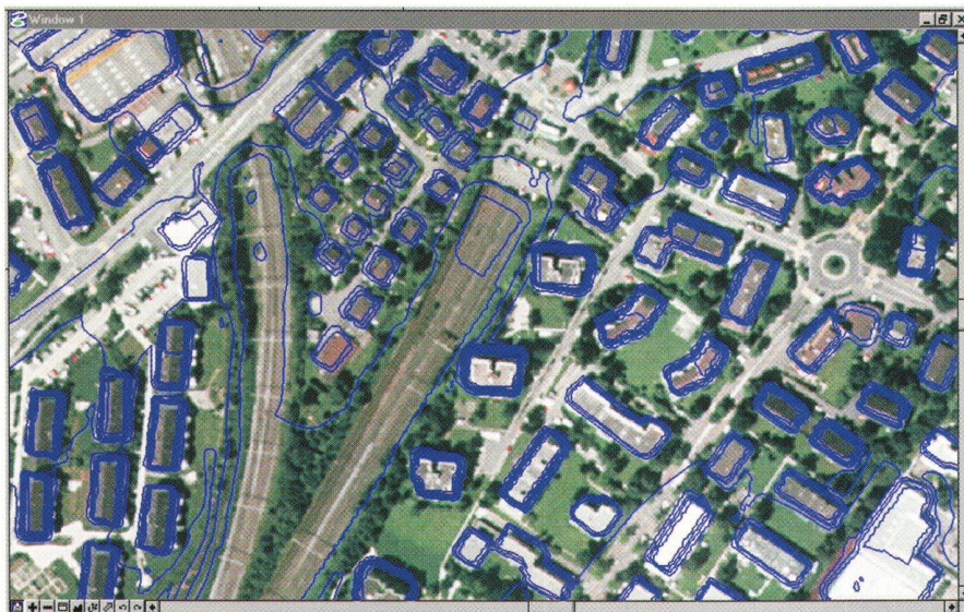
Abb. 8: Qualitätskontrolle DOM/2.5: Überlagerung der Höhenlinien im Swissphoto-Orthophoto.
