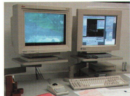
Abb. 1: Digitale photogrammetrische Arbeitsstation DPW770 (links Extraction-Monitor für die Editierung im Stereomodell, rechts Console-Monitor für die graphische Benutzeroberfläche).
