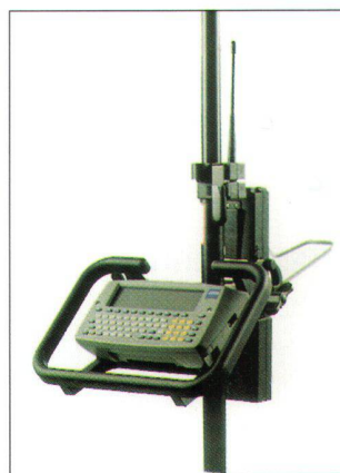
Abb. 2: Zeiss® Elta® Survey Controller im Remote-Modus (neue Halterung!).
