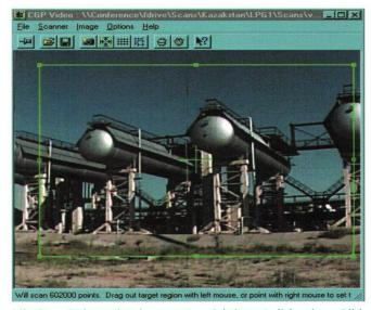
Mit Cyrax<sup>™</sup> ist es in einem ersten Schritt möglich, einen Bildausschnitt auszuwählen. Anschliessend werden hunderttausende Punkte innerhalb dieses Ausschnittes in wenigen Minuten mit einer Genauigkeit von ≤6 Millimetern gemessen und eingescannt.
