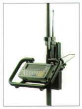
Abb. 2: Zeiss® Elta® Survey Controller im Remote-Modus (neue Halterung!).
