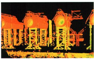
Die eingescannten Punkte bilden Punktwolken, sogenannte Pixel, in unterschiedlichen Farbtönen. Dadurch werden die einzelnen Objektstrukturen gut erkennbar.
