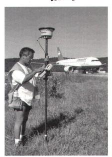
le GPS-Rover 4800 – das Standardgerät auch für den Ausbau des Flughafe
