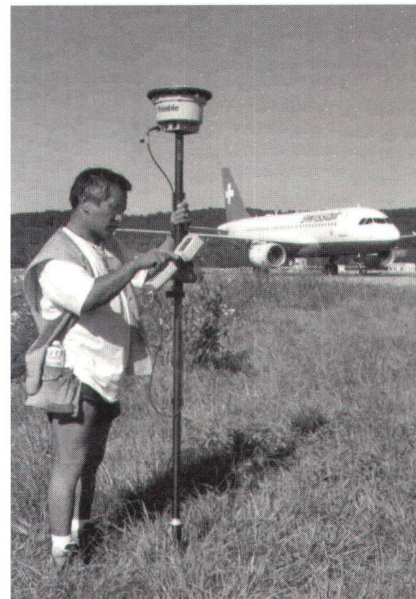
Trimble GPS-Rover 4800 – das Standardgerät auch für den Ausbau des Flughafens Zürich
