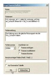
Abb. 3: Diese Regel wird beim Modifizieren eines Features geprüft. Wenn die Nutzungsart einer Haltung geändert wird, wird geprüft, ob sie mit der Nutzungsart des Schachts übereinstimmt. Ist sie nicht erfüllt, so wird die angegebene Fehlermeldung 20004 (ORA-20004) ausgegeben.
