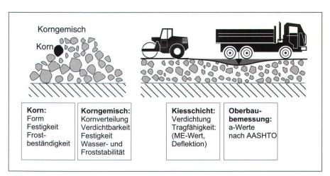
Abb. 1: Strassenoberbau, Qualitätssicherung und Dimensionierung.
