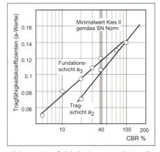
Abb. 4: Tragfähigkeitswerte in Funktion des CBR-Wertes nach AASHTO.
