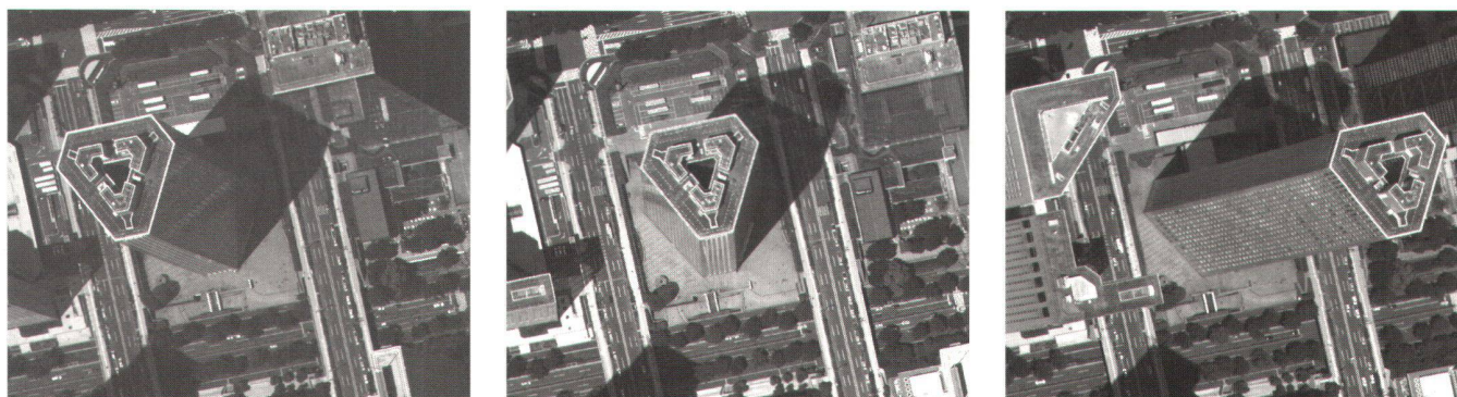
Fig. 4: Shinjuku, Tokyo, Japon. Images panchromatiques arrière, nadir et avant. H = 2000 m s/sol, GSD = 20 cm. Images totales 12 K x 53 K, 25.4 km 2 ; extraits 1120 x 1320, 5.9 ha.
