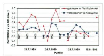
Abb. 6: Korrelation des gemessenen bzw. verbesserten Vertikalwinkels mit den Standardabweichungen in y-Richtung mit mehreren Punkten an verschiedenen Messtagen im Val Nalps bei Sedrun/GR und in Claro/TI.
