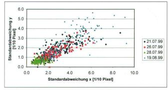
Abb. 4: Standardabweichungen in x- vs. y-Richtung vier verschiedener Messtage im Val Nalps bei Sedrun/GR und in Claro/TI.
