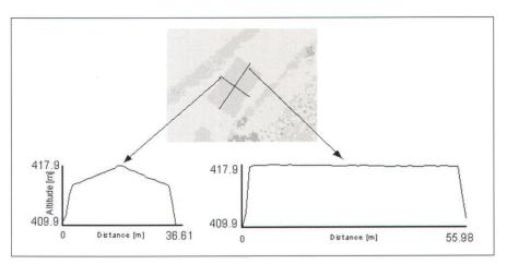
Fig. 9: Profils d'un bâtiment sur un MNS de 1 mètre.
