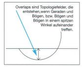
Abb. 3: Toleranzen bei Overlaps.
