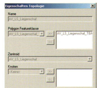
Abb. 1: TB-Admin: Definition einer Polygon-Topologie durch Angabe der Featureklasse der Kanten und der Zentroiden.
