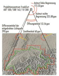
Abb. 3: Ein Grossprojekt, auch was die dargestellte Zone betrifft: Karte mit topografischen Kennwerten und dem Prinzip der mitdrehenden Lichtquelle.
