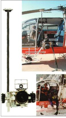
Fig. 7: Le bloc caméra-INS-GPS. Montage sur Alouette III: le système est fixé à l'alouette pendant le vol d'approche, puis détaché pendant la prise de vue. Les vibrations sont amorties par l'opérateur.
