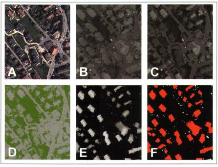
Abb. 4: Gebäudedetektion aus Farbluftbild und Oberflächenmodell; A) Originalbild, B) rotgrün-Kanal a\* des CIELAB Farbraums, C) arithmetische Kombination gr = (g-r) / (g+r), D) Klassifizierungsresultat, E) normalisiertes Oberflächenmodell ohne Vegetation, F) detektierte Gebäude.
