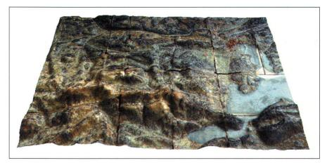
Abb. 5: Der photogrammetrisch rekonstruierte Teil des Pfyffer-Reliefs.
