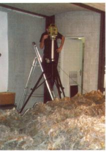
Abb. 4: Trigonometrische Passpunktbestimmung.
