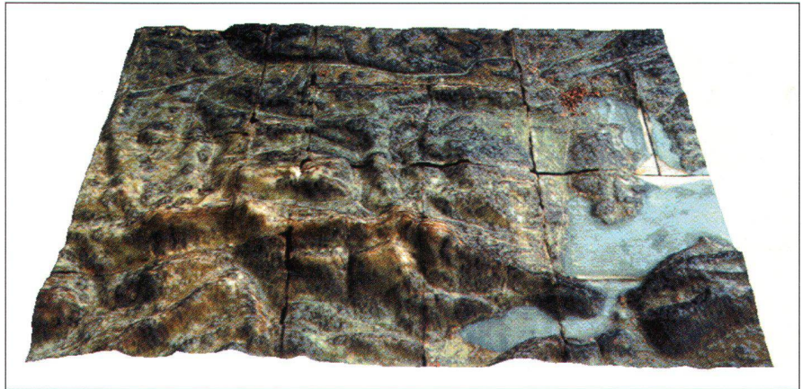
Abb. 5: Der photogrammetrisch rekonstruierte Teil des Pfyffer-Reliefs.
