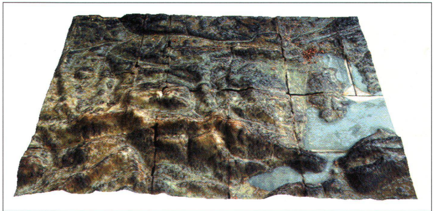
Abb. 5: Der photogrammetrisch rekonstruierte Teil des Pfyffer-Reliefs.
