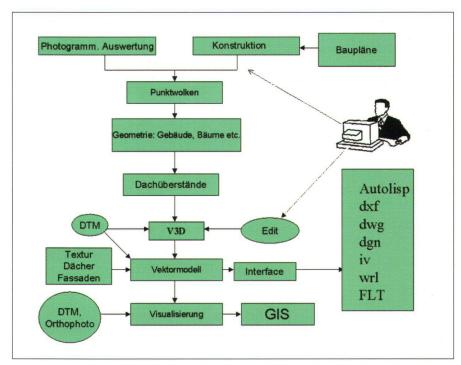
Abb. 1: Datenfluss zur Generierung und Visualisierung von 3D-Stadtmodellen.
