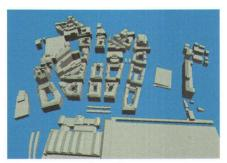
LOD2: Die Dachstrukturen werden zusätzlich geladen.
