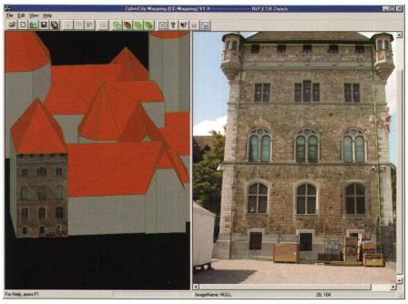
Abb. 4: Anbringen von Fassadenphotos mit CCM.
