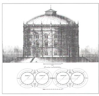
Abb. 1: Der Architektenplan zeigt Industriearchitektur kurz vor der Moderne: Wiens Gasometerbehälter wurden durch dickes Ziegelsteinmauerwerk repräsentativ geschützt.
