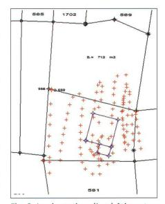
Fig. 3: Implantation d'un bâtiment.
