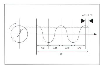
Fig. 1: Représentation graphique de la mesure de la distance D par la méthode de la phase. Le déphasage  $\phi$  est mesuré; l'incertitude sur le nombre entier de demi-longueurs d'onde entières N qui figure dans l'équation est déterminé par l'emploi combiné de plusieurs longueurs d'onde.
