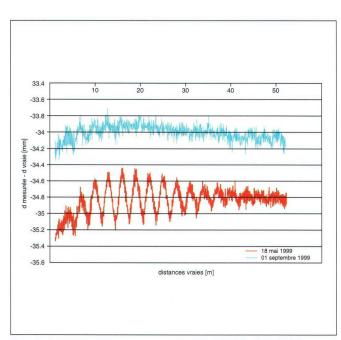
Fig. 3: Courbes d'étalonnage du TDA5005 n°438198 avant et après modification. Un décalage vertical de 1 mm a été introduit entre les deux courbes pour en faciliter la lecture: les cycles ont disparu après la modification en usine.
