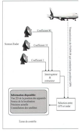
Fig. 3: Schéma de l'intégration de la position GPS.
