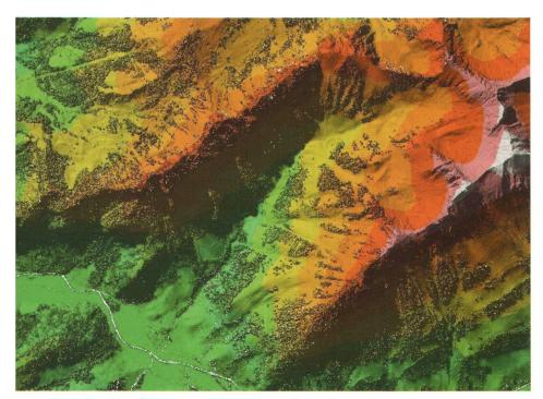
Digitales Oberflächenmodell aus Laser Scanning.
