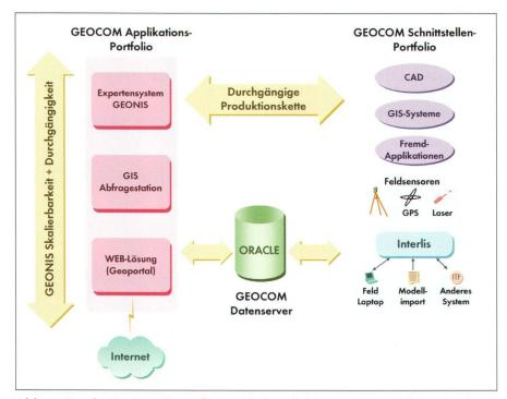
Abb. 1: Durchgängiger Datenfluss zwischen Feldsensoren und Datenbank.
