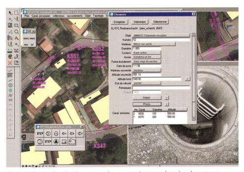
Fig. 1: GEONIS, plan de réseau pour les eaux usées avec données de mensuration officielle et orthophoto, attributs de la cheminée sélectionnée.
