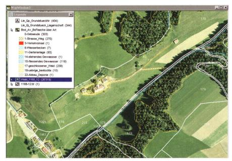
Abb. 4: Bodenbedeckung mit Orthofoto.
