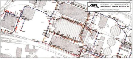
Abb. 4: Abwasser-Zustandsplan (z.V.g. von Sennhauser, Werner & Rauch AG).
