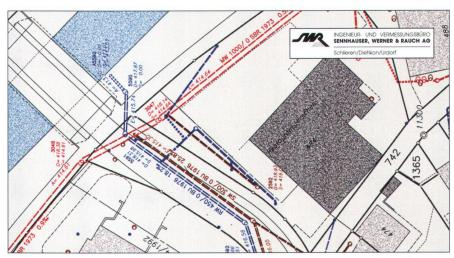
Abb. 5: Werkleitungsplan (z.V.g. von Sennhauser, Werner & Rauch AG).
