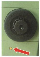
Abb. 3: Neben dem Okular befindet sich eine gelbe Kontrollleuchte. Beim Auslösen einer reflektorlosen Distanzmessung leuchtet die Kontrollleuchte so lange, bis die Messung beendet ist.
