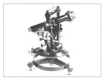
Abb. 5: Triangulationstheodolit von Srb und Štys.
