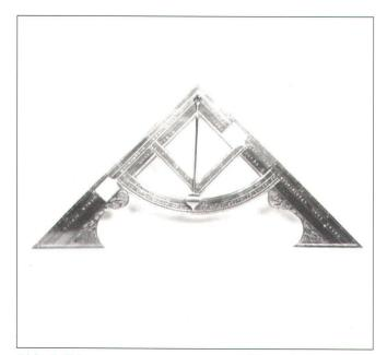
Abb. 1: Schrotwaage von Erasmus Habermel.
