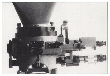
Abb. 9: Detailaufnahme des Messtheodolites. Es sind ersichtlich: Ablesemikroskop rechts oben, darunter Fernrohr, Prismen für die Beleuchtung der Teilung, in der Öffnung unterhalb des Kamerakorbes ist das Kameraprisma knapp sichtbar. Aufnahme von P. Fülscher.
