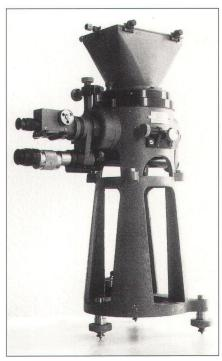
Abb. 8: Gesamtansicht des Messtheodoliten, Aufnahme von P. Fülscher.
