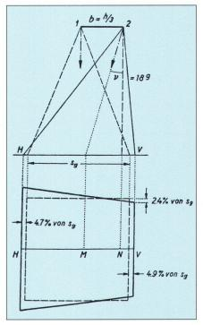
Abb. 3: Disposition von «normal-konvergenten» Aufnahmen aus Zeller, Lehrbuch der Photogrammetrie.
