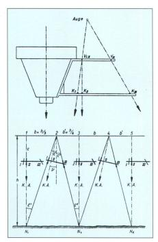
Abb. 4: Visiere an der Wildkamera und die Kamerastellungen für «normalkonvergente» Aufnahmen aus Zeller, Lehrbuch der Photogrammetrie.
