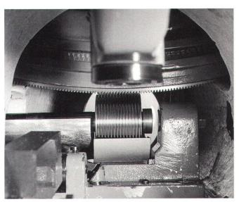
Abb. 4: Blick durch das in Abb. 1 erwähnte Schauloch. Die Schnecke ist mit dem Zahnkranz im Eingriff, jedoch vom achsialen Anschlag am Plättchen rechts von der Schnecke zurückgezogen. Die Schnecke trägt in der Achse eine eingepresste Kugel, die im Betrieb am gehärteten Plättchen anliegt. Zur Schmierung des Zahnkranzes liegt die untere Hälfte der Schnecke in einer Ölwanne.
