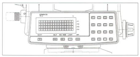
Abb. 3: Bedienungsterminal TR10 (Ausschnitt aus einer Konstruktionszeichnung).
