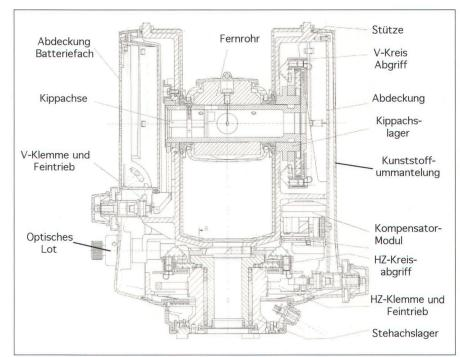
Abb. 2: Schnitt durch den «E10».
