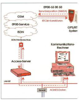
Abb. 1: Funktionsprinzip von swipos-GIS/GEO.
