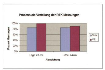
Abb. 6: Prozentuale Verteilung aller Messungen (blau) und der Messungen mit der virtuellen Referenzstation (violett).
