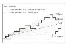
Abb. 2: Bestimmung des ersten bewegten Punktes, Unterteilung der groben Randlinie in zwei Polygone.
