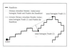
Abb. 4: Wiederholung des Schrittes von Abb. 3, bis keine weiteren bewegten Punkte mehr gefunden werden.
